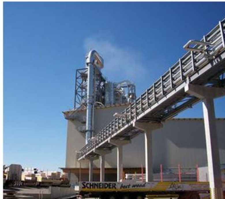
Impianto di produzione della fibra di legno 3therm. Lo scarto viene polverizzato, ed aspirato all'altezza di 58m in 7 secondi alla temperatura di 140°C
